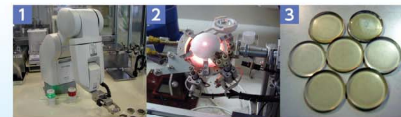
1: ハンドリングロボットによる正確な受け渡し 2: 高周波加熱熔融 3: 作製したガラスビード
