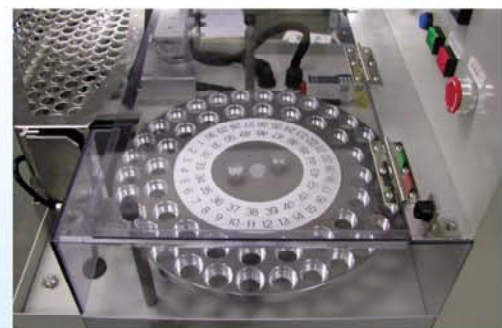
るつぼをセットするターンテーブルは20個用と50個用があります。
