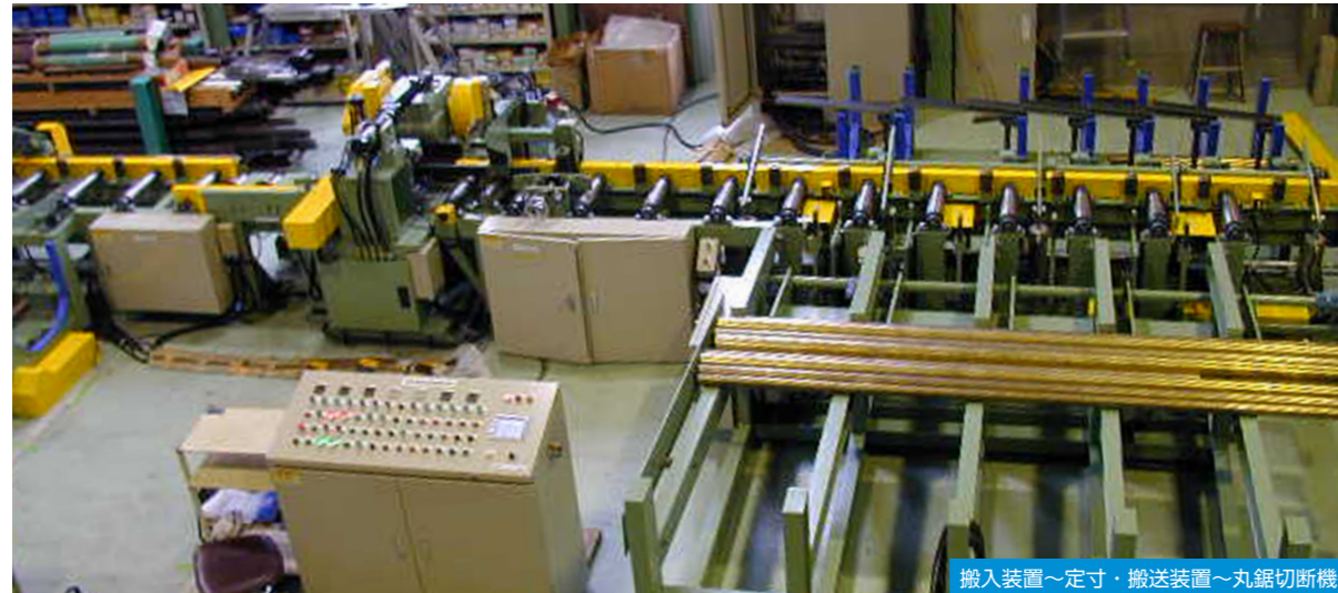
搬入装置～定寸・搬送装置～丸鋸切断機
